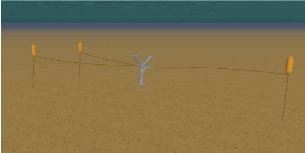
Hình 64: Các loại chân đế: Các thiết bị thể hệ thứ hai - Hệ thống neo sử dụng dây và phao. [7]
