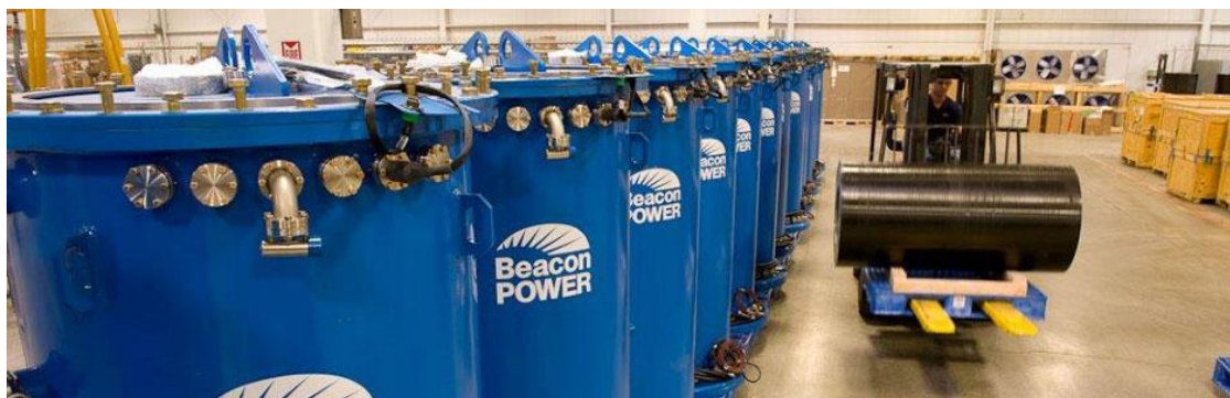
Hình 29: Ảnh bánh đà của Beacon Power [6]. Một bánh đà bằng sợi tổng hợp khác do xe nâng đang vận chuyển phía phải. Mỗi bánh đà có công suất 100 kW. Ảnh chụp tại kho của nhà sản xuất.
